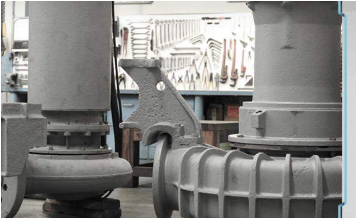
Figura 1. Recubrimiento cerámico de una bomba industrial
